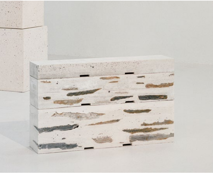
Prototype de béton d’ardoise développé pour le concours de la salle de spectacle d’Avrillé / photo : Charles Bouchaïb
